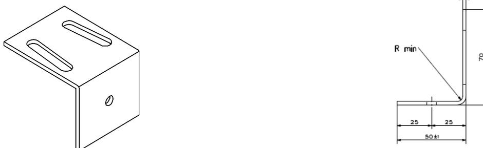
Note: Per ancoraggio su travi non designate. Si fissa con bulloni M8 + autofilettante (non fornita).
